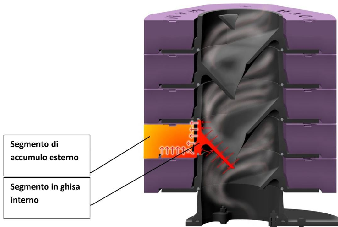
Per questo motivo, per la conduzione termica in profondità, Romotop MAMMOTH utilizza dei segmenti interni in lega di qualità. Questo materiale è in grado di condurre il calore fino a 40 volte più velocemente rispetto ai materiali ceramici o in cemento utilizzati per la costruzione degli anelli di accumulatore. Il segmento interno in lega è addirittura dotato sulla sua circonferenza di un anello a forma piatta che conduce il calore negli strati esterni dei segmenti di accumulatore.
